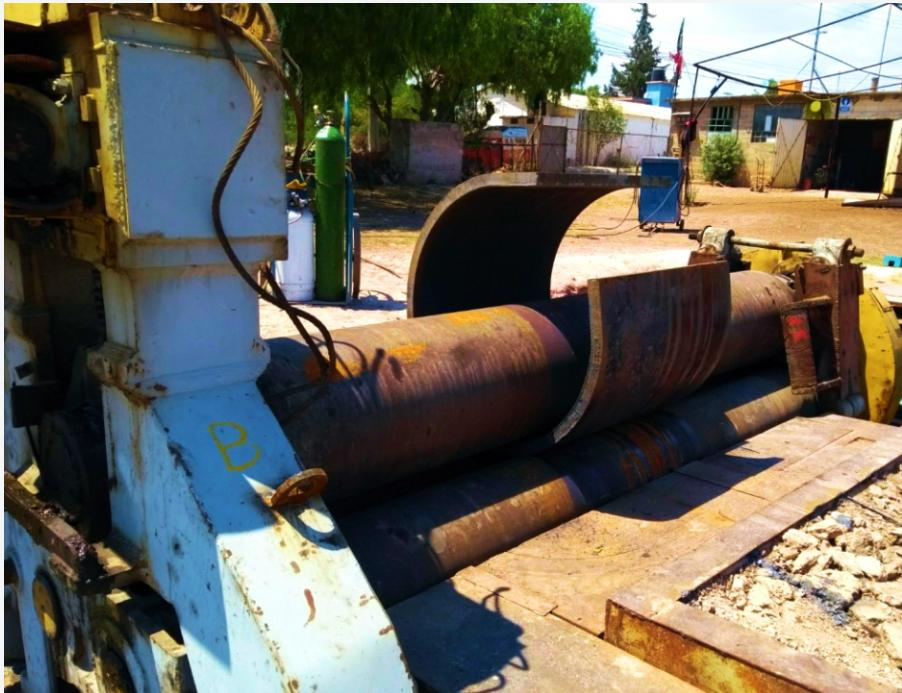
**Fabricación de CONO en acero INOX de 2" de esp.**
